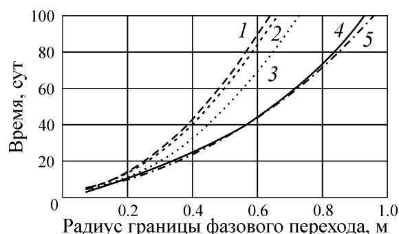
Рис. 3. Динамика границы фазового перехода грунтовых вод: 1 — задача Стефана в общем виде; 2 — квазистационарный подход; 3 — нестационарная диффузионная теплопроводность без учета теплоты фазового перехода; 4 — стационарная диффузионная теплопроводность с учетом теплоты фазового перехода; 5 — метод электротепловой аналогии
