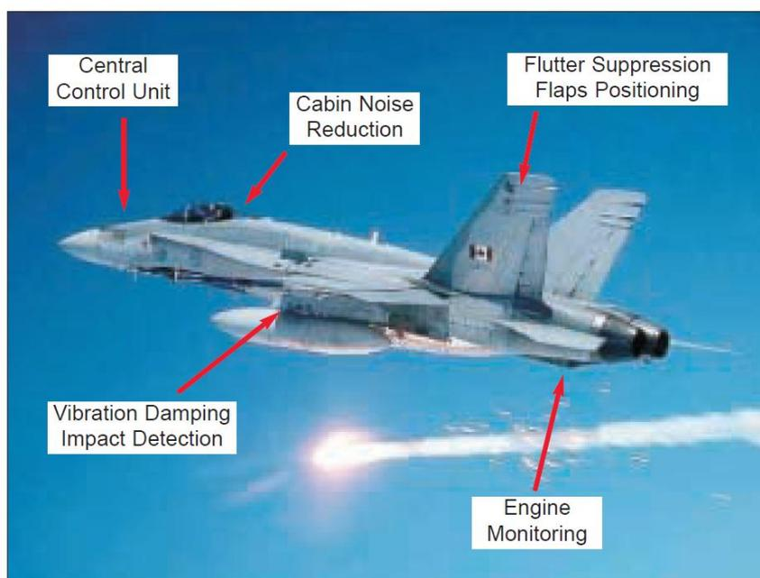
Рис. 4. Применение smart-технологий в авиации [1]
