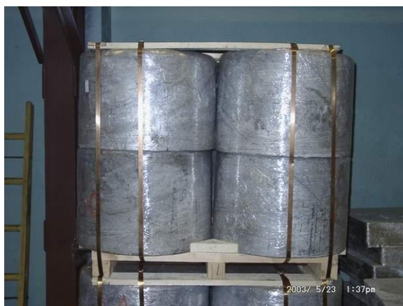
Рис.4.18. Крупногабаритные слитки магния, отлитые при помощи МГД-насоса Пуш-пул.
