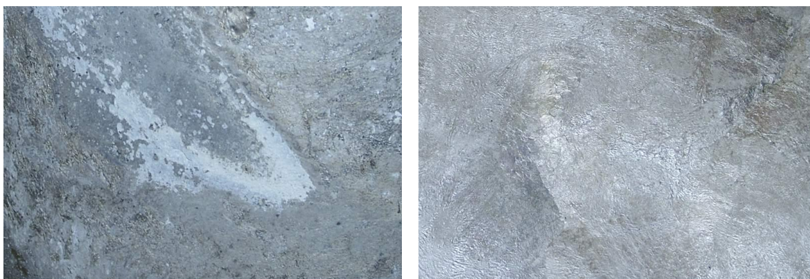
Рис.4.23. Солевые включения на поверхности слитка отлитого обычным способом (слева). Чистая поверхность слитка (без солевых включений) отлитого МГД-насосом (справа).
