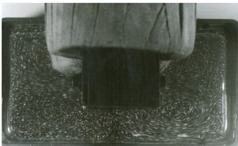
Рис.3.18. Моделирование (индукционным способом) четырехконтурной циркуляции в ванне с галлиевым сплавом. Для визуализации течения поверх слоя металла налит тонкий слой слабой соляной кислоты.
