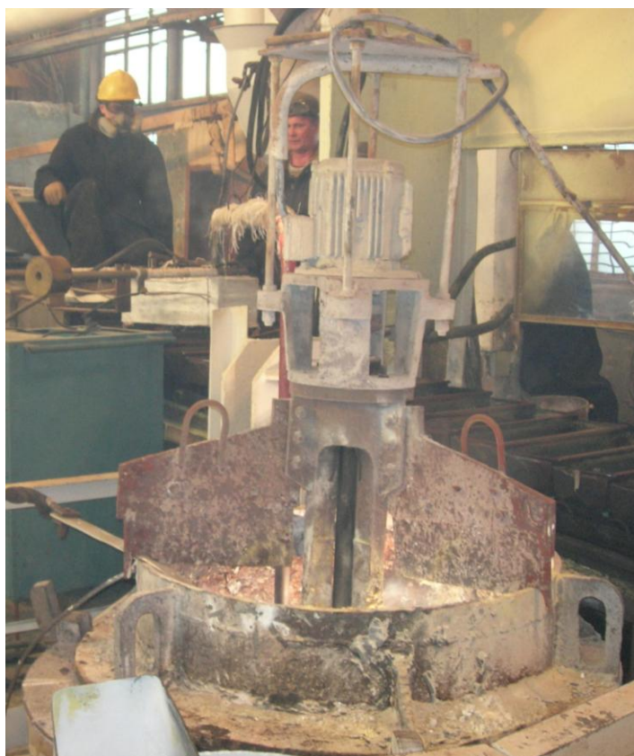
Рис.4.2. Розлив жидкого магния в слитки на конвейер при помощи механического центробежного насоса (на переднем плане).
