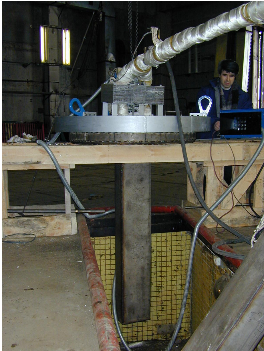
Рис.4.75. Погружной двухкамерный насос для жидкого магния.
