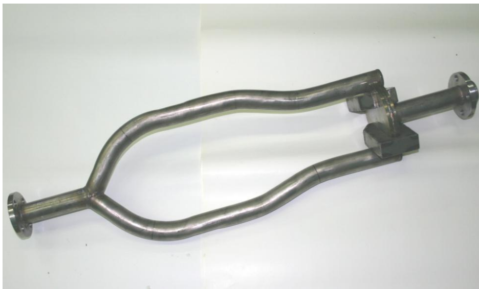
Рис.5.39. Экспериментальная модель электровихревого центробежного насоса. На фото справа виден цилиндрический плоский канал с входным патрубком и двумя П-образными сердечниками. Выходные патрубки (круглые) соединяются в петлю, в которой специальным трансформатором (на фото отсутствует) индуцируется рабочий электрический ток.
