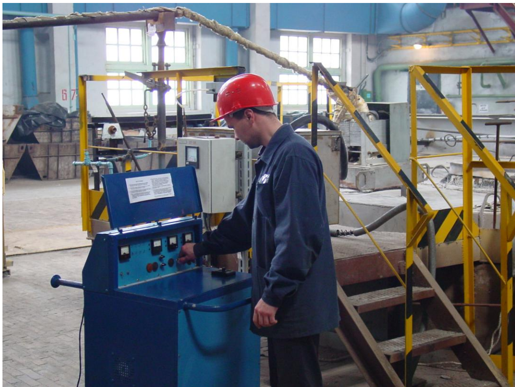
Рис.4.77. Рабочий литейщик, управляя насосом, ведет процесс отливки крупногабаритного магниевого слитка (5 тонн) на ОАО «АВИСМА».
