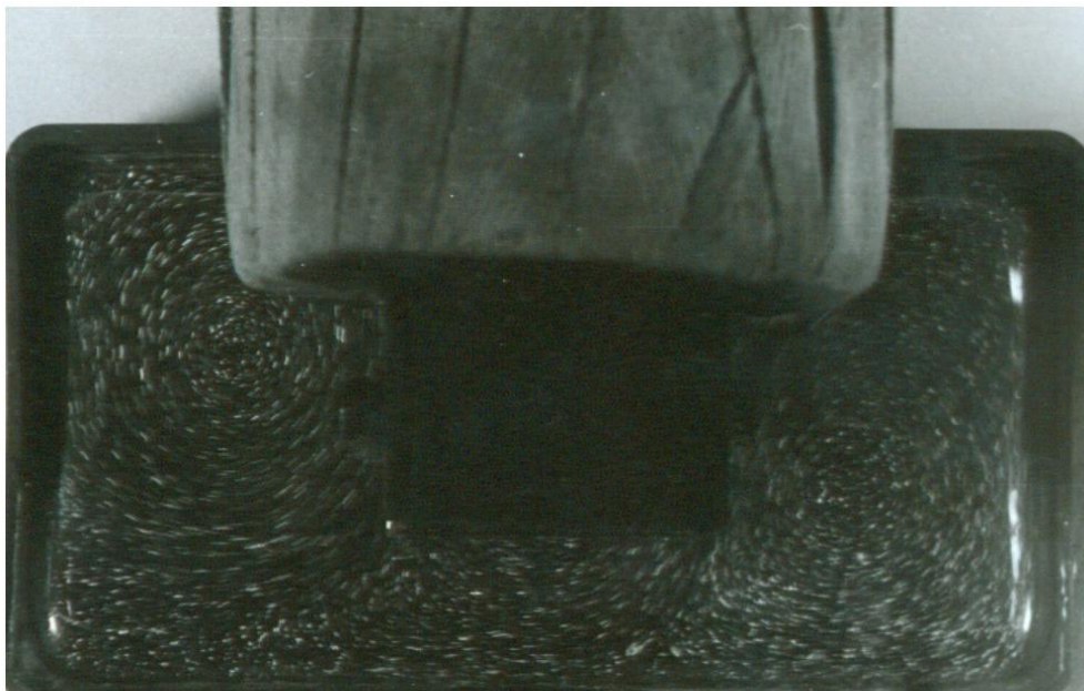
Рис.3.20. Попеременное усиление диагональных вихрей при четырехконтурной циркуляции, при усилении интенсивности течения.
