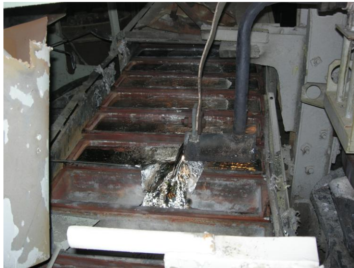
Рис.4.20. Момент розлива магния в изложницы на конвейере при помощи насоса.
