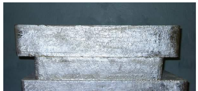
Рис.4.18. Крупногабаритные слитки магния, отлитые при помощи МГД-насоса Пуш-пул.
