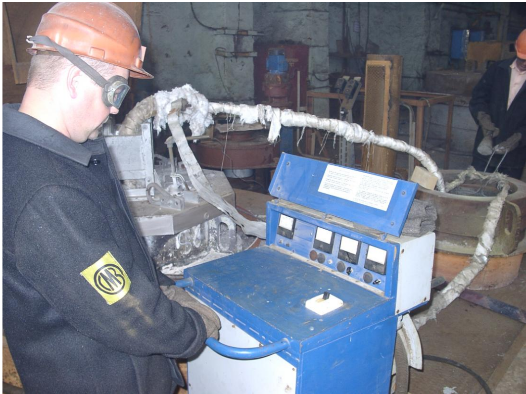
Рис.4.71. Рабочий литейщик управляет работой погружного МГД-насоса в процессе литья круглых крупногабаритных слитков.
