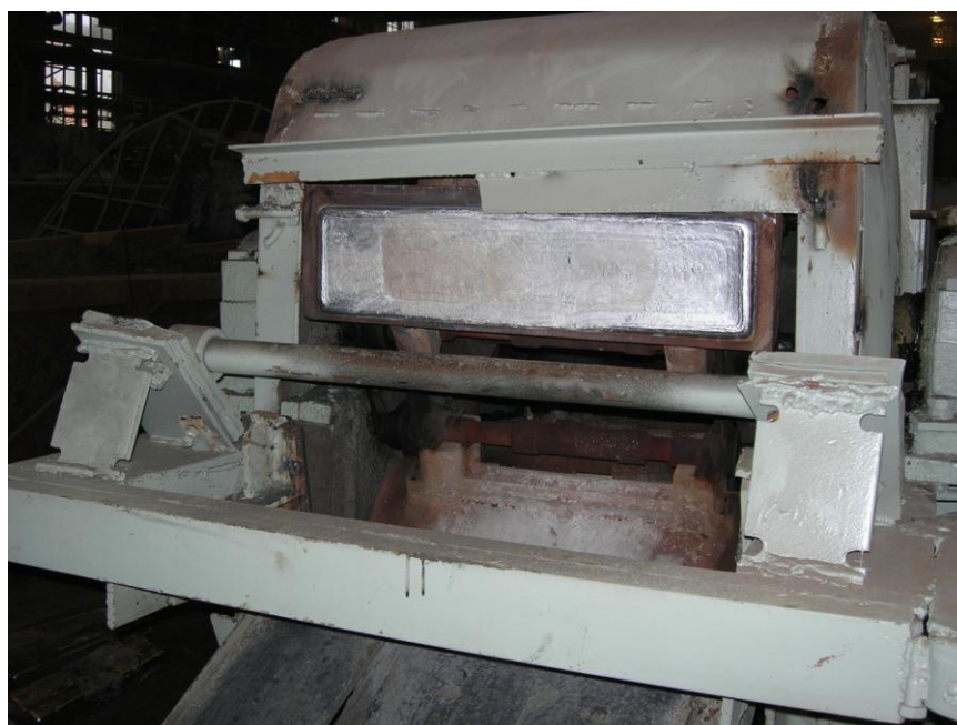
Рис.4.22. Выход слитка с литейного конвейера при литье магния насосом.
