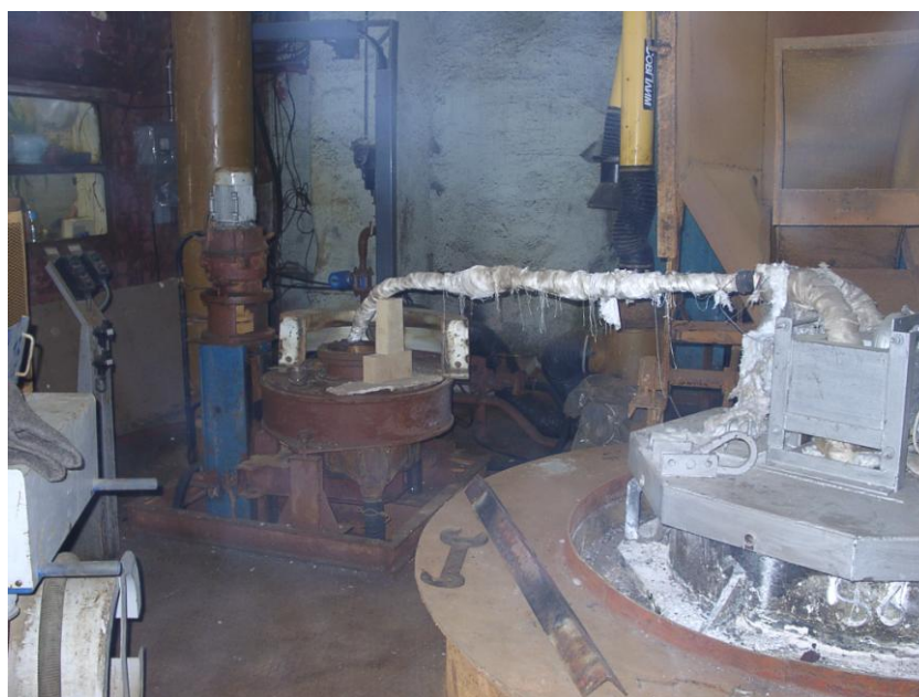
Рис.4.70. Однокамерный центробежный электровихревой (погружной) насос (на переднем плане справа) подает магний в установку непрерывного литья круглых магниевых слитков (на заднем плане).
