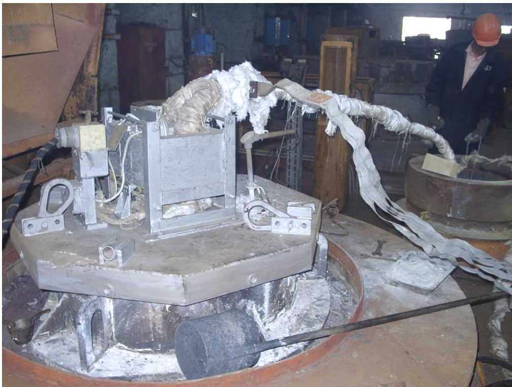
Рис.4.67. Литье крупногабаритных слитков из тигля при помощи погружного МГД-насоса.
