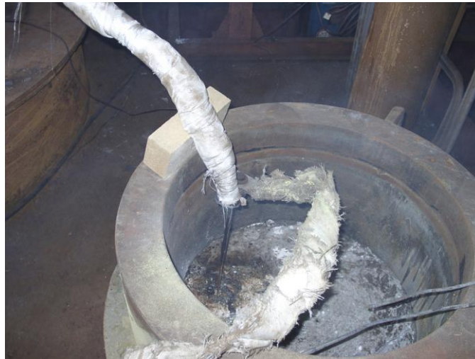
Рис.4.7. Заливка жидкого магния в изложницу крупногабаритного слитка при помощи погружного МГД-насоса с проводящими перегородками в канале.
