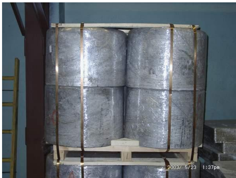
Рис.4.69. Крупногабаритные круглые слитки магния, отлитые при помощи однокамерного электровихревого МГД-насоса
