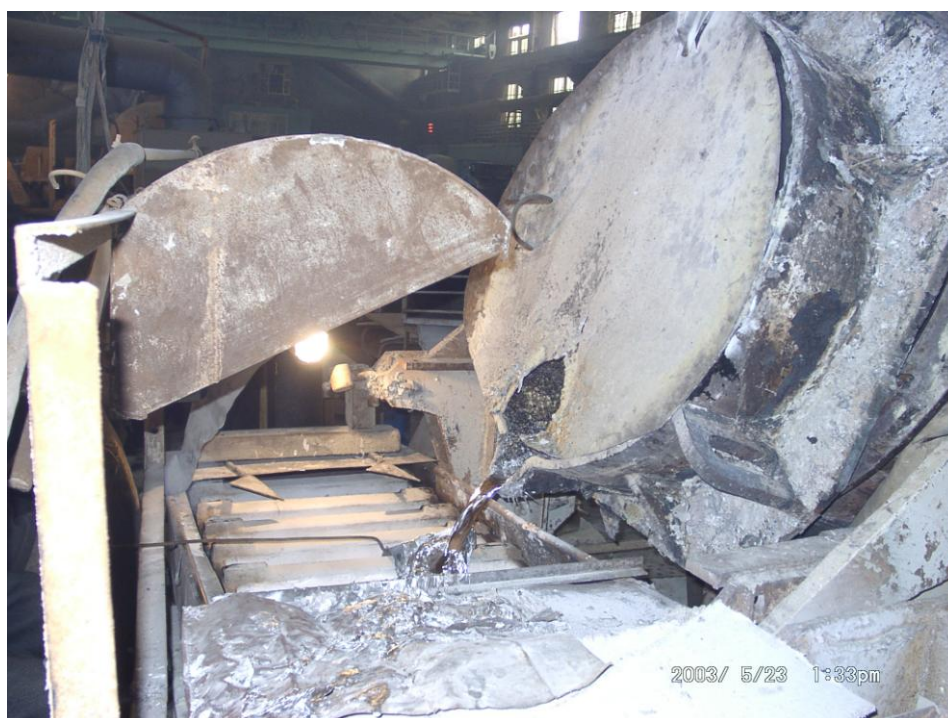
Рис.4.1. Розлив жидкого магния в слитки на конвейере из ковша, наклоняемого гидравлическим механизмом.
