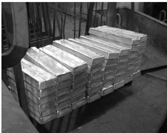
Рис. 4.19. Слитки розлитые МГД-насосом на литейном конвейере
