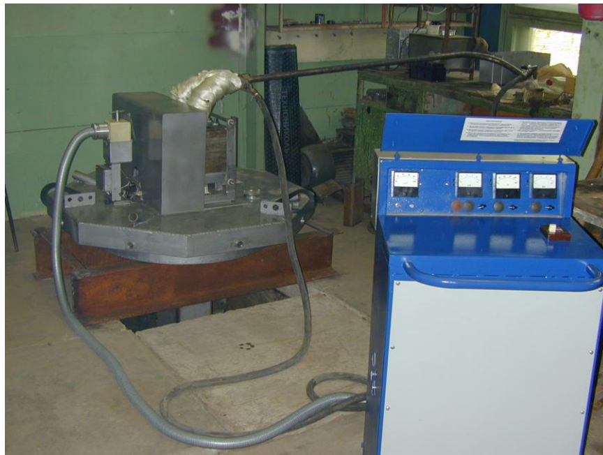
Рис.4.66. Погружной МГД-насос (слева) и пульт управления (справа)
