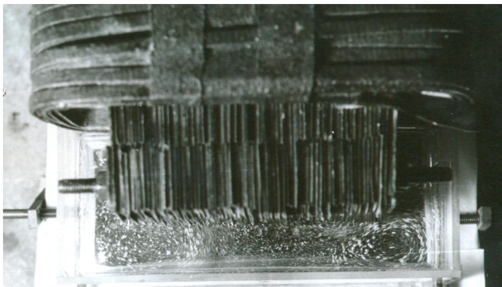
Рис. 3.17. Индукционная экспериментальная установка, в которой форма ванны и сечение полюса индуктора геометрически подобны форме ванны и анодного массива реального промышленного электролизера. На фото видна многоконтурная циркуляция, генерируемая индуктором в слое металла.
