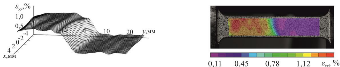
Рис. 3. Неоднородное поле продольных деформаций при движении полосы Чернова-Людерса
