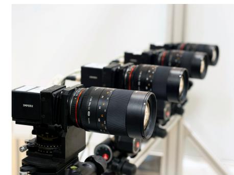
Система предназначена для анализа трёхмерных полей скорости потока жидкости и газа в объёме. Для реализации измерений применяются четыре регистрирующие камеры, лазерная система или светодиодный осветитель для засветки потока. Обработка получаемых изображений основана на технике томографического PIV (Tomo PIV).
