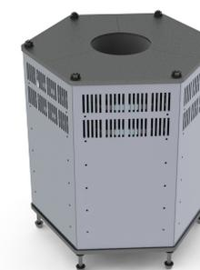
Главным преимуществом использования электромагнитного перемешивателя является значительное улучшение качества формируемого слитка. Потоки, создаваемые в жидком металле, способствуют равномерному распределению легирующих элементов и примесей в расплаве, а также обеспечивают однородность размера зерна в готовом материале. Это особенно важно для производства высококачественных алюминиевых сплавов, где требуются стабильные механические и физические свойства продукции.
