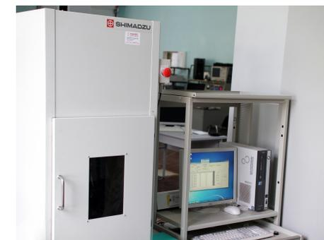
Проведение усталостных испытаний образцов из металлов и сплавов в резонансном режиме с частотой нагружения 20 кГц, что позволяет достичь базы нагружения  $10^9$ – $10^{10}$  циклов за несколько дней. Характерной особенностью разрушения при таких испытаниях является образование трещины внутри материала, а не на его поверхности.
