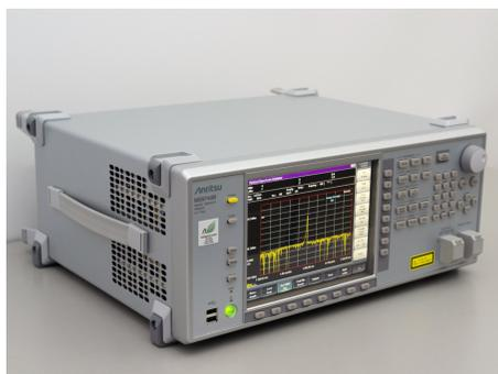
Обладает широким динамическим диапазоном, высокой скоростью развёртки в диапазоне длин волн от 600 до 1750 нм и высоким разрешением. Поддерживает многомодовое оптическое волокно. Позволяет одновременно измерять центральную длину волны, OSNR, ширину спектра и т.д., а также отображать эти результаты на одном экране.
