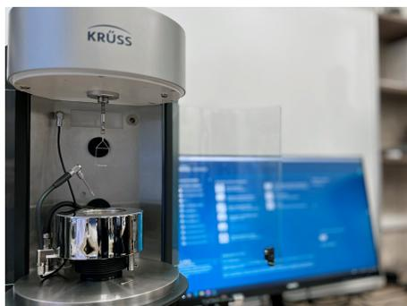
Программно-аппаратный комплекс для измерения динамического поверхностного натяжения методом максимального давления в пузырьке в диапазоне возраста поверхности от 5 мс до 200 с. Возможен расчёт равновесного значения поверхностного натяжения по уравнению Хуа и Розена, а также коэффициентов диффузии и адсорбции.
