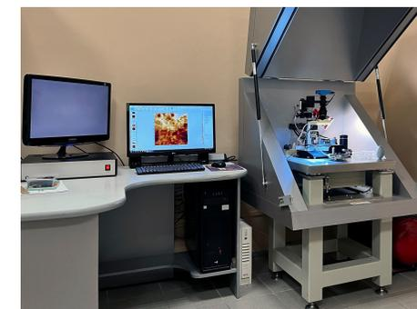
Сканирующий зондовый микроскоп, позволяющий исследовать поверхностные и подповерхностные свойства материалов на микро- и наноуровне.
