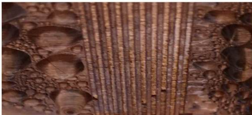
Рисунок 3.1 — Фотография, демонстрирующая капельный характер конденсации водяного пара на охлаждаемом медном теплообменнике. Капли в канавках дренажируются капиллярными силами.
