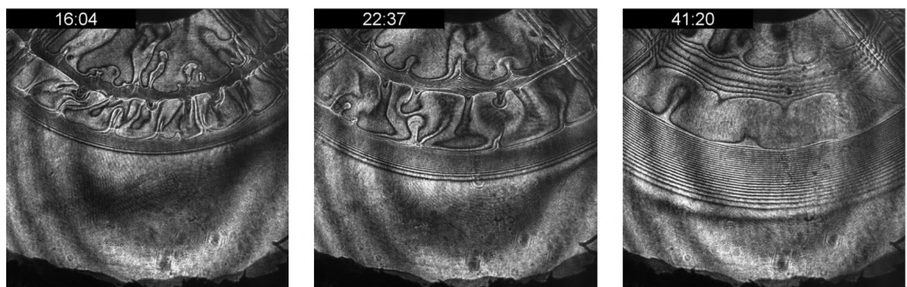
Рисунок 1.7 — Структура течения в системе смешивающихся реагирующих жидкостей во вращающейся ячейке Хеле-Шоу в последовательные моменты времени [158].
