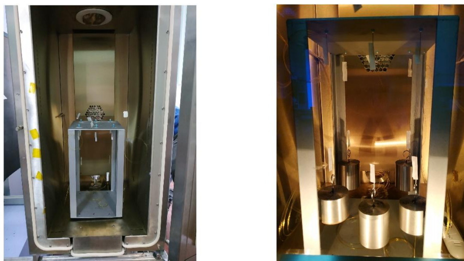
Рисунок 1.20 — Экспериментальная установка для длительного испытания ВОД при постоянном уровне температуры
