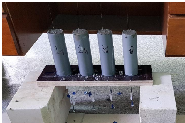
Рисунок 2.2 — Образцы из цементного раствора ( а ) и фотография сечения образца в области внедрённого оптоволоконна ( б )
