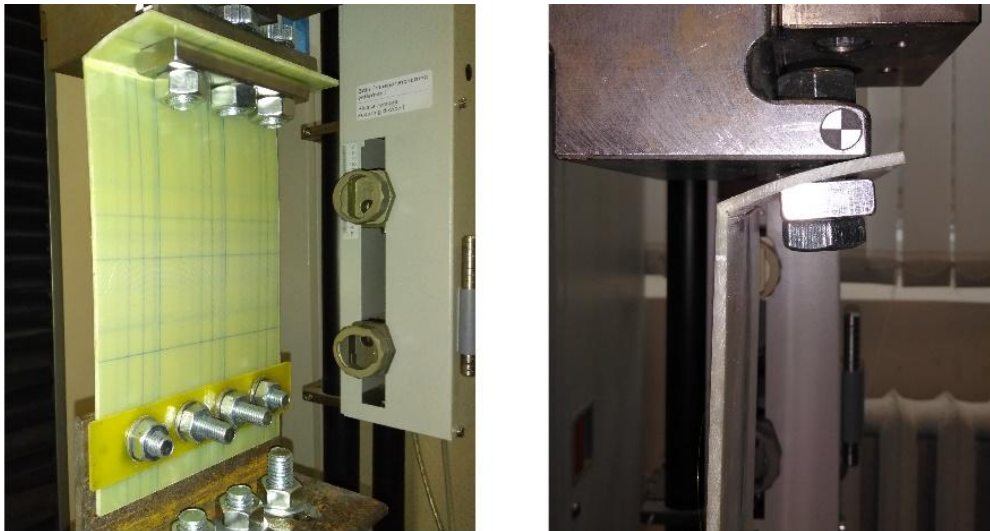
Рисунок 4.11 — Образец в форме уголка при испытании на растяжение
