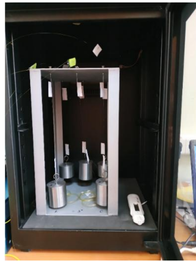
Рисунок 1.19 — Схема оснастки с оптическими волокнами и грузами и вид оснастки, помещенной в экспериментальную установку
