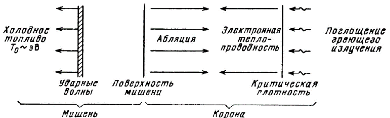
Рисунок 1.2 – Разлет оболочки DT-мишени в результате воздействия лазерного излучения с оболочкой мишени в инерциальном термоядерном синтезе
