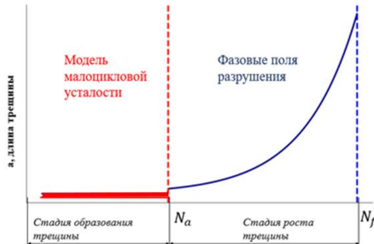
Рис. 4.4.4. Эволюция трещины в зависимости от числа циклов нагружения. N_a — количество циклов до образования трещины, N_f — суммарная долговечность, включающая стадии образования и распространения трещины.
