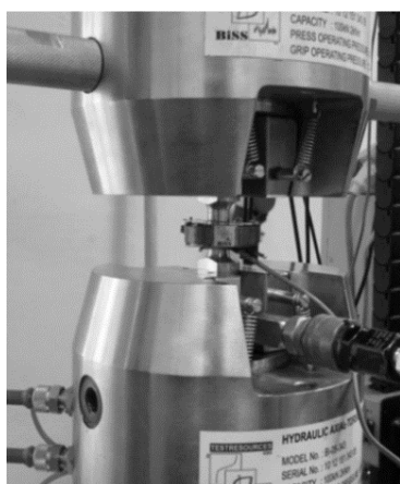
Рис. 2.3.3. Испытательная установка (а) и образец с концентратором напряжений (б)
