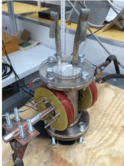
Рис. 2.3. Фотоизображение установки, заполненной галлиевой эвтектикой, в отсутствие теплоизоляции
