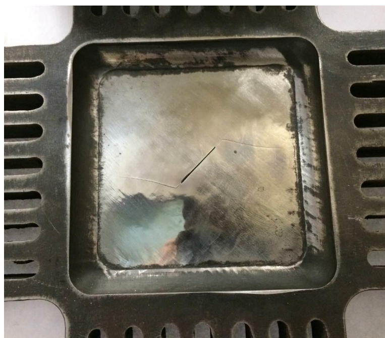
Рис. 4.8. Траектория развития трещины в образце с утонением (CS-2) для классического случая чистого сдвига (Mode II)
