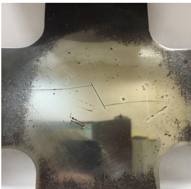
Рис.4.6. Траектория развития трещины в плоском образце (CS-1) при одноосном растяжении с ориентацией исходного надреза под углом 25^\circ
