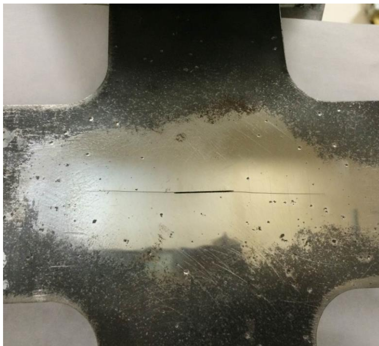
Рис.4.5. Траектория развития трещины в плоском образце (CS-1) при нормальном отрыве (Mode I)
