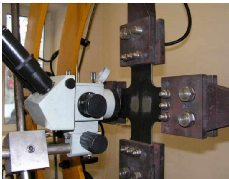
Рис.2.19 измерение приращения длины трещины на свободной поверхности образца.
