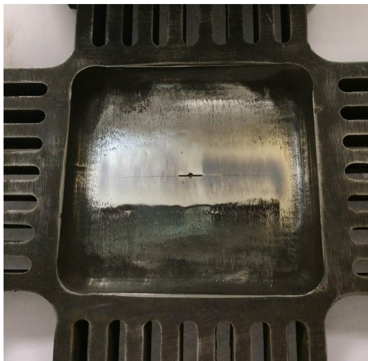
Рис. 4.7. Траектория развития трещины в образце с утонением (CS-2) при нормальном отрыве (Mode I)
