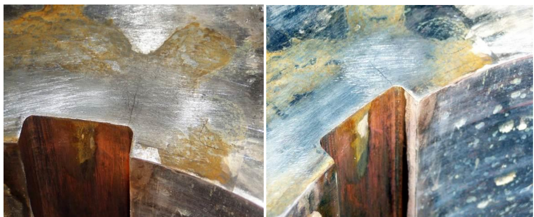
Рис.5.4. Эксплуатационное повреждение диска 22-й ступени паровой турбины
