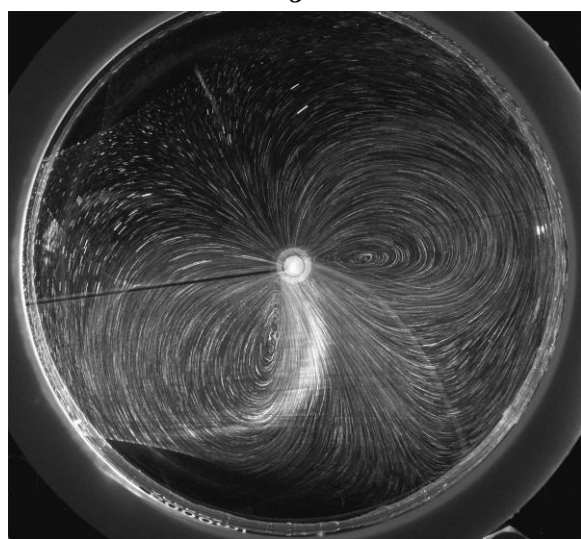
Рис. 2.4. Картины течения, наблюдаемые на поверхности воды при \tilde{C} = 10\% , q = 0.052 г/с и \Gamma / \Gamma_e : ( a ) – 0.075, ( б ) – 0.15, ( в ) – 0.225, ( г ) – 0.40, ( д ) – 0.45, ( e ) – 0.50
