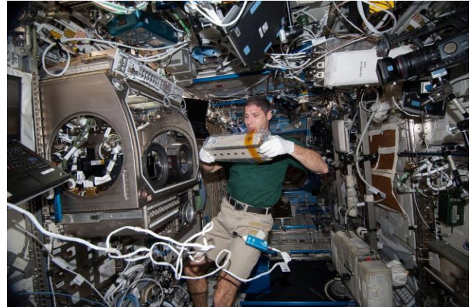
Рис. 3. Астронавт Майк Хопкинс монтирует блок ячеек DCMIX в модуль SODI
