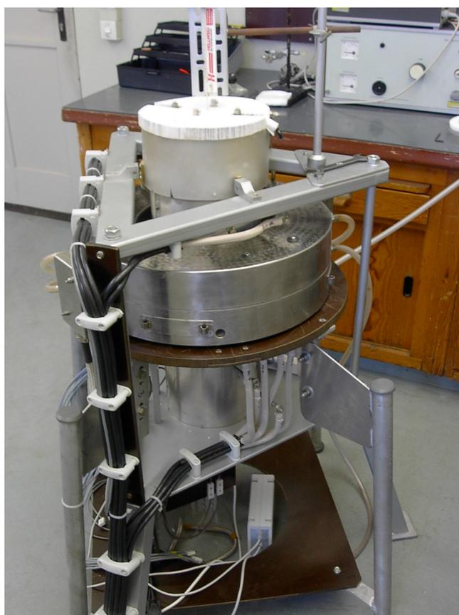
Рис. 1.24 Общий вид 2-дюймовой печи *VGF*
