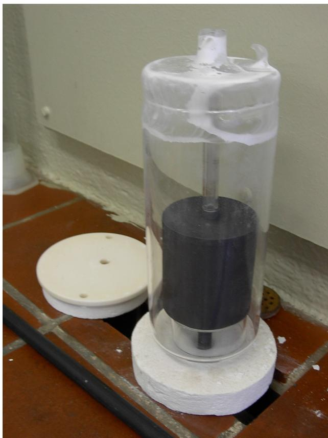
Рис. 1.25 Тестовая 2-дюймовая ампула в сборе. Виден осевой канал, через который посредством подвижной термопары производится измерение температуры
